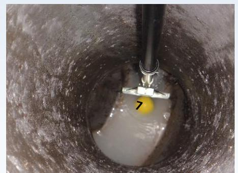
「通る君」は、ナンバリング(0~8)された球体と粉体が一包化されています。2種類を同時に、トイレから流して地上の污水枘に流れってくる白い水と球体を確認できれば、污水管に致命的な破損はないと診断できトイレが使えます。
